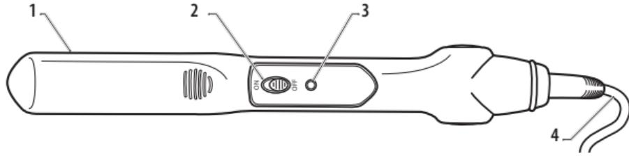
**1 Sildošā plāksne****2 Ieslēgšanas/izslēgšanas poga****3 Tīkla sprieguma gaismas indikators****4 Elektrības vads****IESLĒGŠANA**
